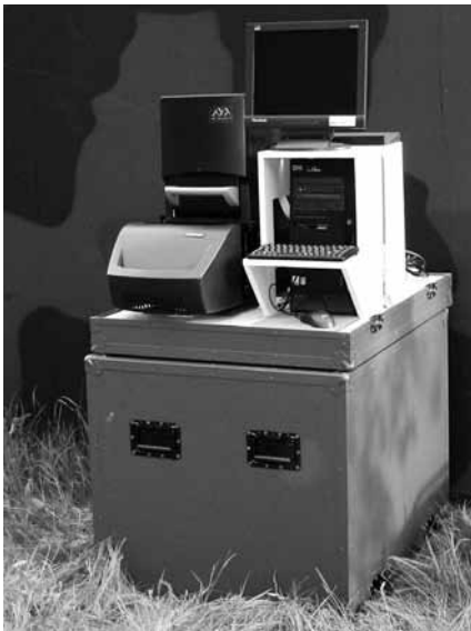
Abb. 82: PCR-System: Geräte dieses Typs sind seit Januar 2002 bei Einheiten der Deutschen Marine zur B-Kampfstoffidentifizierung im Einsatz
