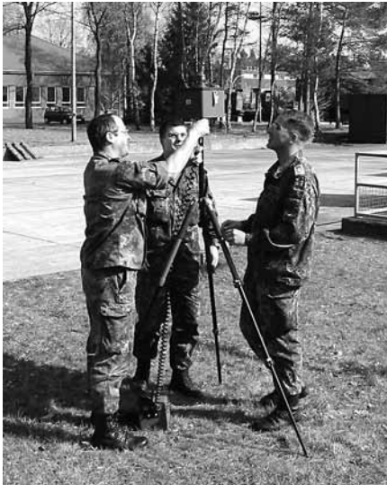
Abb. 81: BAWS-System: Aerosol-Warnsystem, bestehend aus mehreren autonomen Einzeldetektoren (Bild) und einem zentralen Steuerrechner zur großräumigen Überwachung und Absicherung von kritischer Infrastruktur
