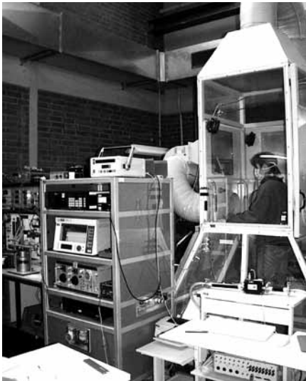
Abb. 19: Prüfaerosol: NaCl Laufband (v): 6 km/h Übungen: Gehen Gehen+ Kopfdrehen Gehen+ Kopfnicken Gehen+ Sprechübung Gehen Probenahme: 2 Minuten/Übung Gesamtprüfzeit: ca. 20 Minuten Belastungsprofil/-simulation: Mittelschwere Arbeit
