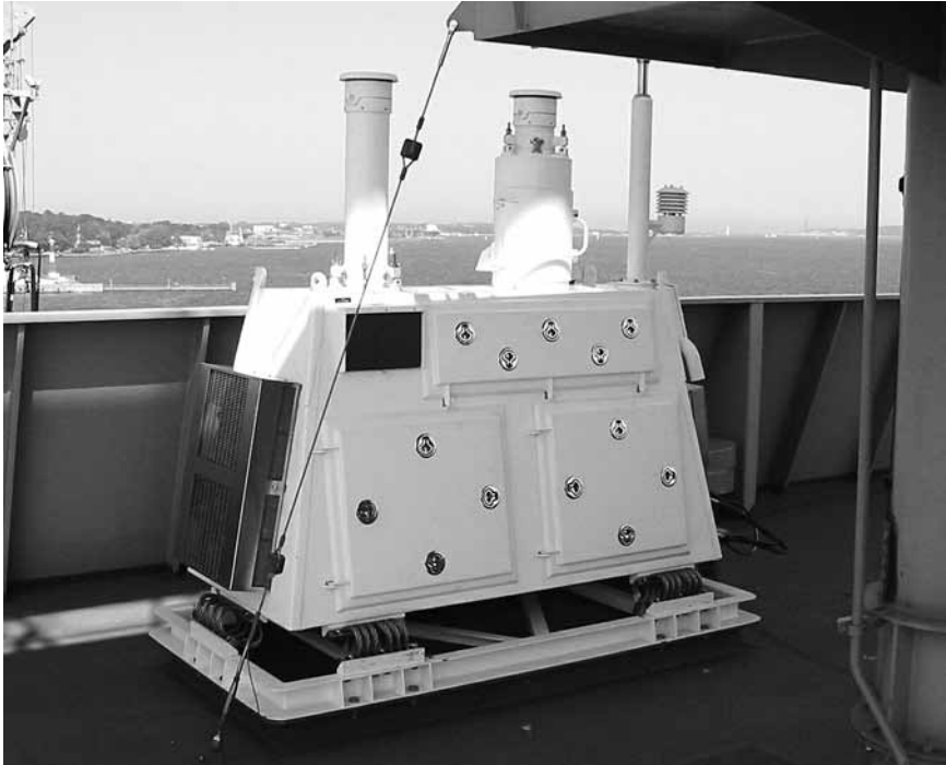
Abb. 80: BWAAW-System: Kontinuierlich arbeitendes Bioaerosol-Warnsystem der Deutschen Marine
